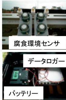
太陽電池とバッテリーを併用した開発システムによる屋外での実証試験の概況（千葉県銚子市）。3年以上、連続測定中。
