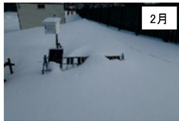
北海道石狩市の暴露試験サイトでの腐食モニタリング状況。積雪により低い暴露架台はほぼ雪で覆われている（右写真）。寒冷地においても、2年以上連続測定中。
