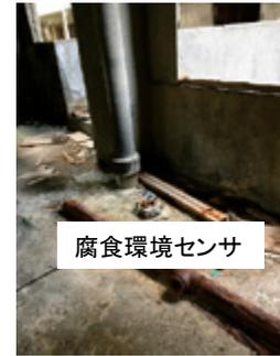
実際の環境での腐食モニタリングの状況（長崎県軍艦島16号棟）。1年以上、連続測定中。
