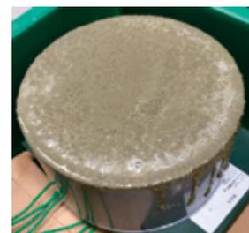
モルタル供試体は、塩ビ製治具にかぶり径が 5、10、20、30mm になるように腐食センサを設置し、練り混ぜたモルタルを流し込むことにより作製（サイズは内径 146mm、高さ 60mm）。モルタルの組成は細骨材：水：セメントの比が 3：1：0.6。
